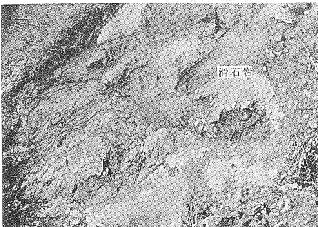
写真-6 宇部（B）での斜面Ⅲの滑落崖近傍のすべり面に見られる滑石岩
