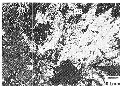
写真-1 5 宇部 (B) での斜面 V で採取した蛇紋岩のホルンフェルス (No. iii) の偏光顕微鏡写真 (直交ポラー) (ol, かんらん石; se, 蛇紋石; tr, 透角閃石)
