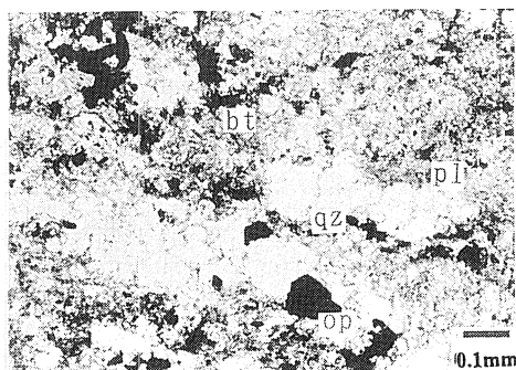
写真-1 6 美東での斜面 I で採取した泥質片岩のホルンフェルス (No. i) の偏光顕微鏡写真 (単ポラー) (bt, 黒雲母; pl, 斜長石; qz, 石英; op, 不透明鉱物)
