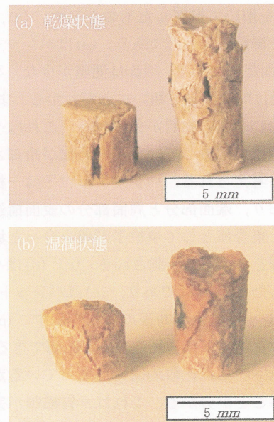
写真-4 供試体の破壊状況
