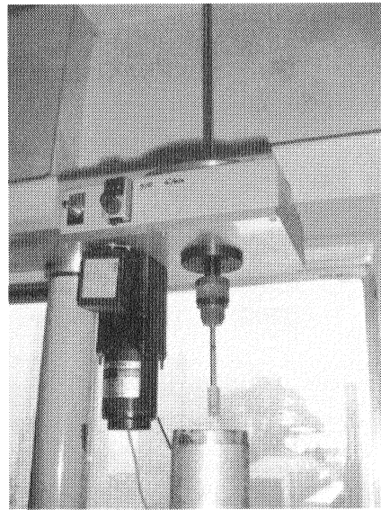
写真-2 室内ベーンせん断試験装置
