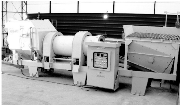
写真-1 半水石膏製造装置
