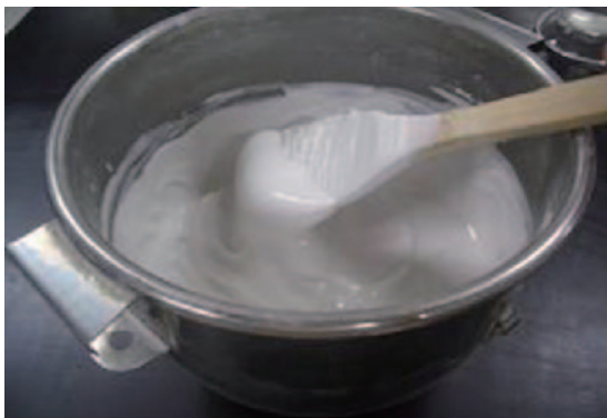
写真-6 本研究で使用した W/S=140%の MC クレー
