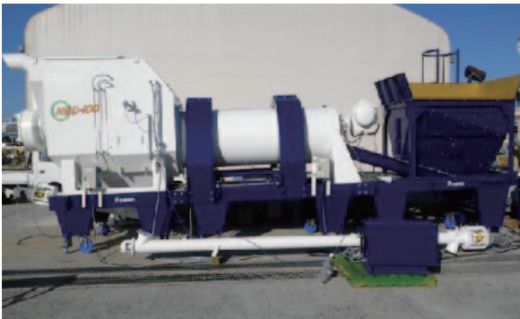
写真-2 本研究で使用した半水石膏製造装置 29)
