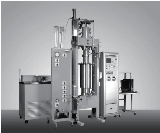
写真-1 恒温高压三軸圧縮試験機の外観
