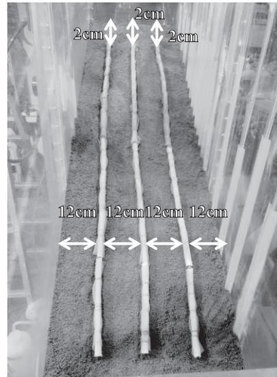
写真-6 ケース 6 におけるパイプの設置状況
