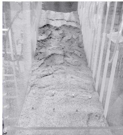
写真-4 ケース4における実験終了時の斜面状況
