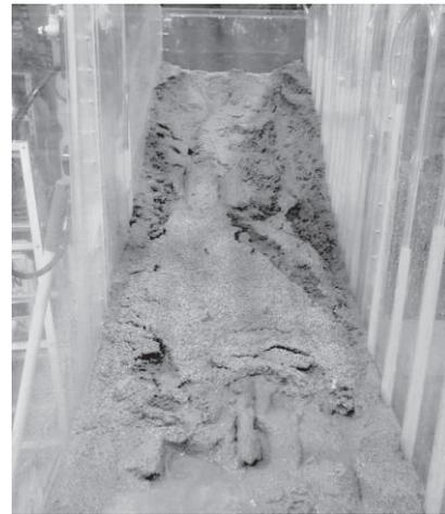
写真-5 ケース5における実験終了時の斜面状況
