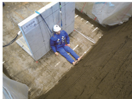
図-11 斜面の前方に設置した擁壁およびマネキン
