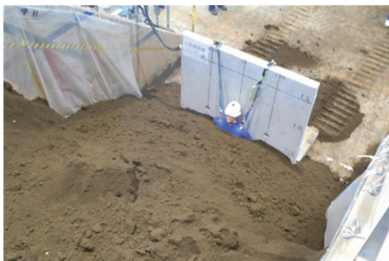
図-13 ケース A のマネキン埋没の様子および断面図
