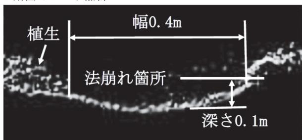
(a) b断面のレーザ点群
