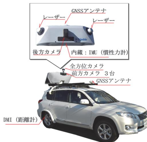
図-1 本研究にて使用するMMSの概要
