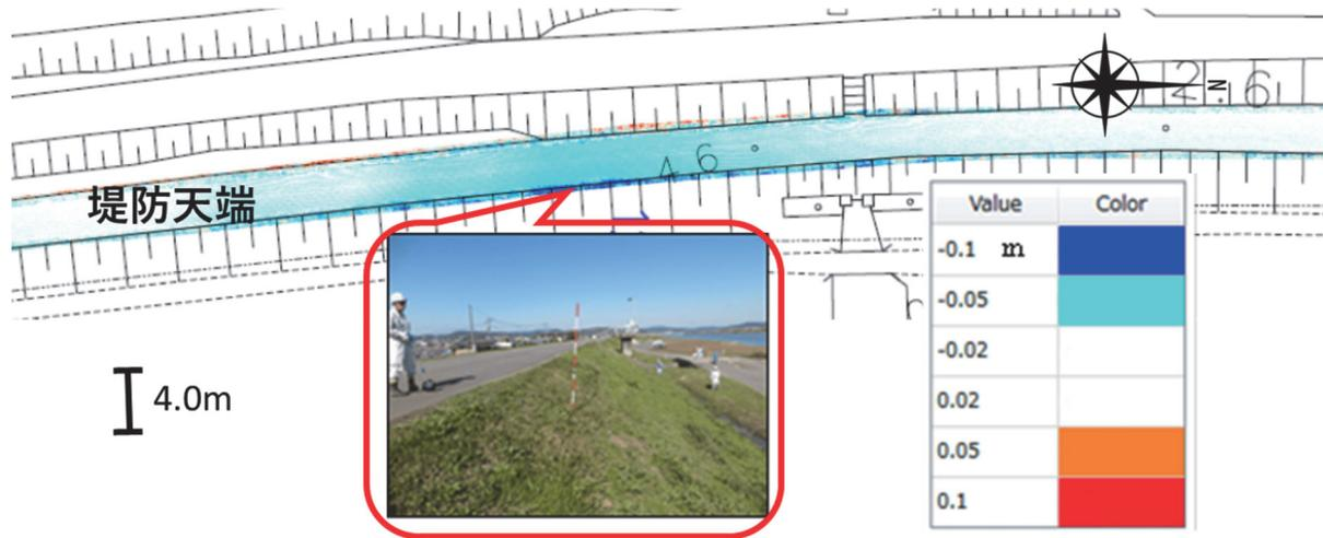
図-16 2 時期の計測データから変状の経時変化を定量化した例
