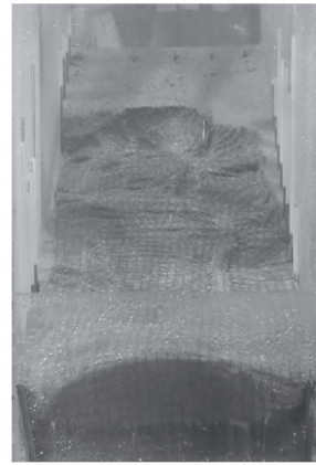
写真-3 ケース 4 における崩壊時の斜面状況
