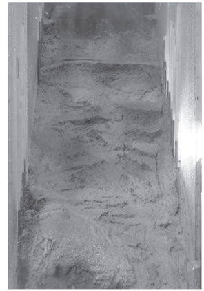
写真-4 ケース 5 における崩壊時の斜面状況
