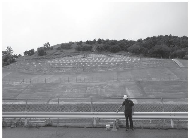
写真-2 斜面崩壊地点付近での常時微動計測状況
