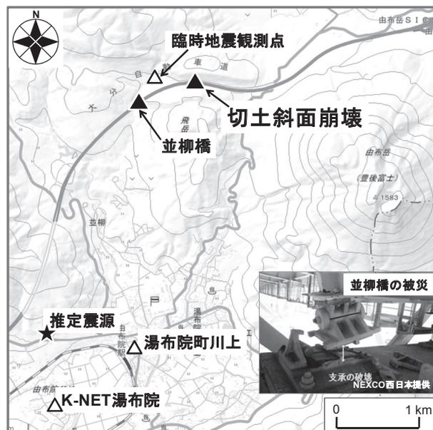
図-1 斜面崩壊地点とその近傍で発生した並柳橋の被災状況、および斜面崩壊地点周辺の強震観測点の分布(国土地理院電子国土Webによる地形図に一部加筆)
