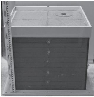
写真-1 土槽に製作した模擬地盤
