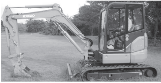
図-2 本研究で使用したミニショベル (コベルコ SK45SR ゴムクローラタイプ)
