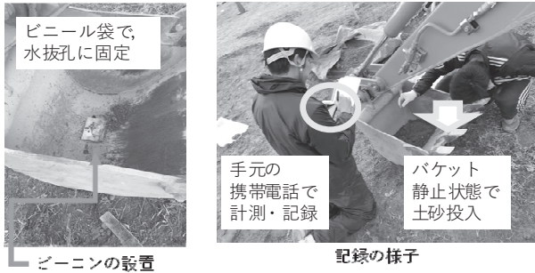
図-19 ビーコンの設置と含水比計測実験の状況
