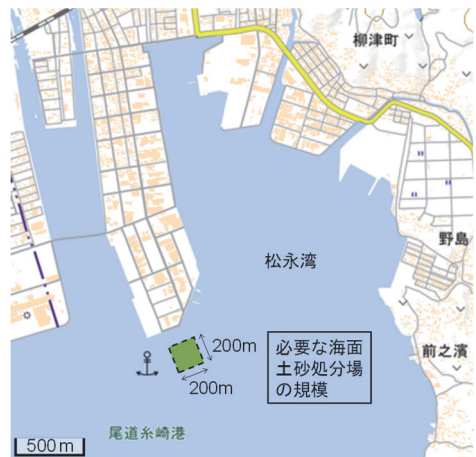
図-11 尾道糸崎港の海面土砂処分場の必要規模 (国土地理院の電子地形図に追記)
