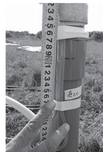
写真-6 マノメータによる計測（受信孔）
