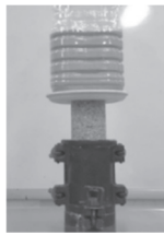
写真-1 供試体におもりを載せた様子
