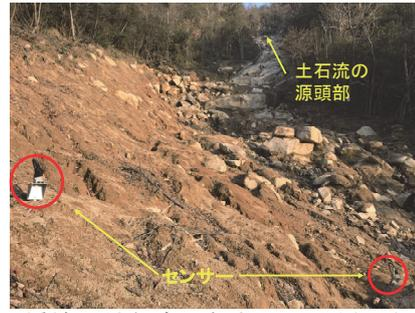
図-12 溪流の地盤内に打ち込み設置した土石流センサーと溪流内の位置(測点5)
