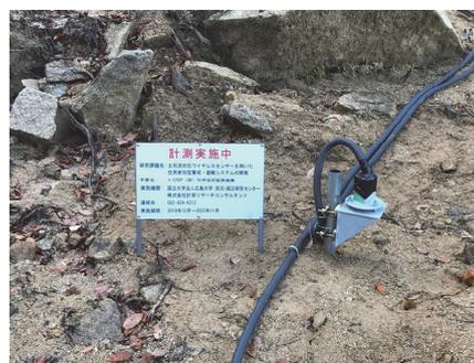
図-11 溪流の地盤内に打ち込んで設置した土石流センサー
