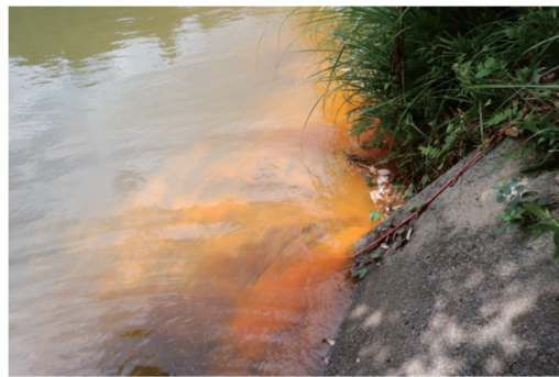
図-17 朱墨による漏水箇所調査状況
