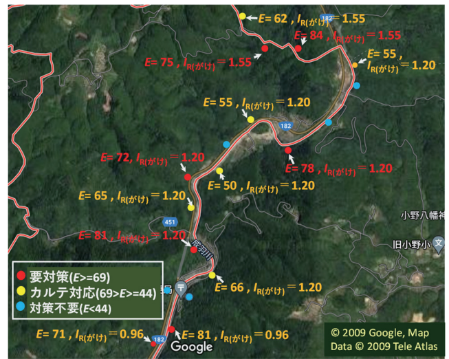
図-18 3D 斜面台帳による斜面の危険度評価値 E と雨量による危険度 I_R のリアルタイム表示のイメージ図
