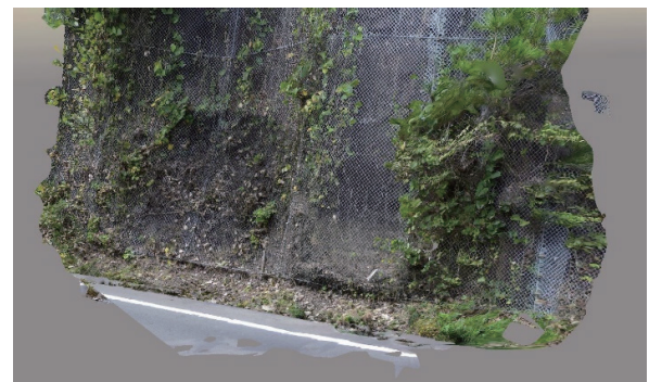
図-3 ロックネット部の地上 SfM 計測結果
