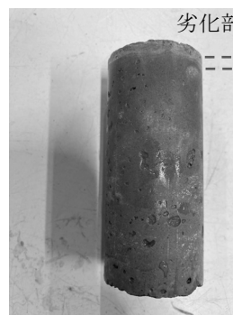
図-4 曝露後の供試体
