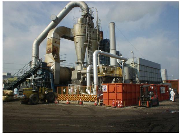
写真-1 油汚染土壌浄化システム
