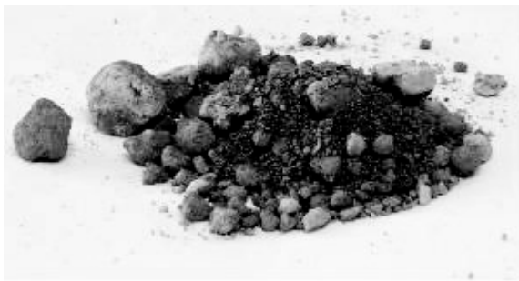
写真-1 製鋼スラグの性状 (CS-20)
