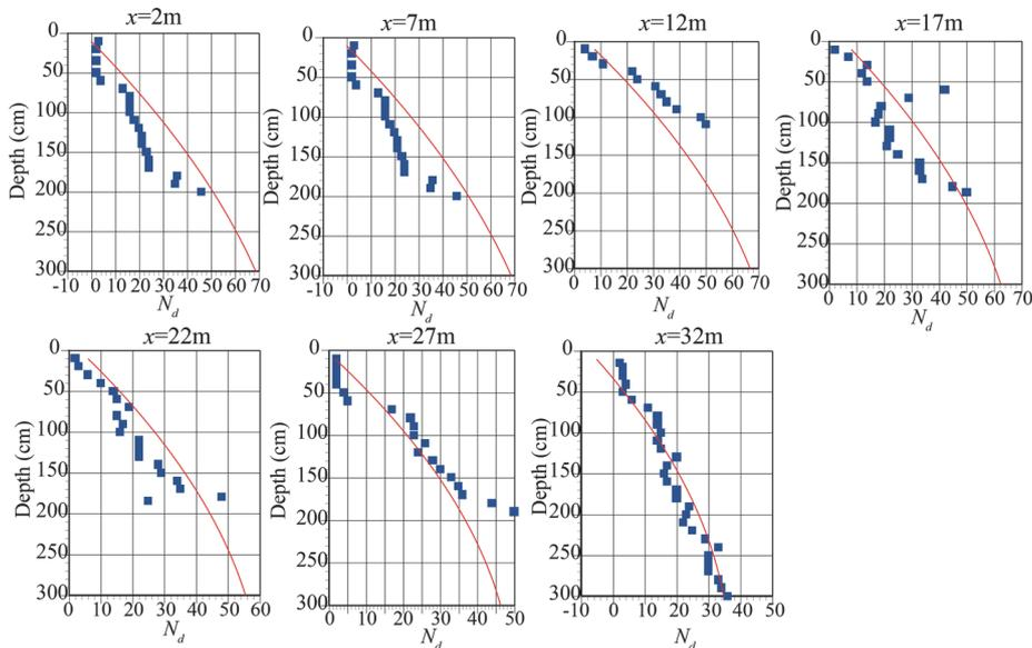
図-8 切り土斜面における DCP 結果  $N_d$  の計測結果と平均値関数
