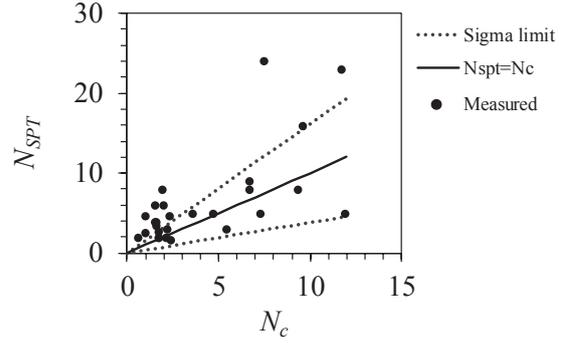
図-3 標準貫入試験値  $N_{SPT}$  と CPT の結果に基づく換算 N 値  $N_c$  の相関性
