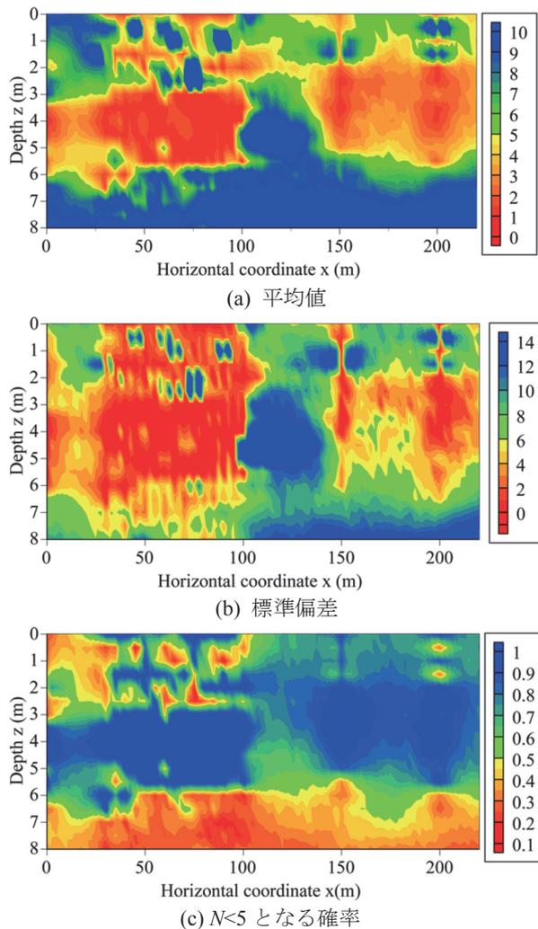
図-12 IS による  $N_{SPT}$  分布 (CPT に基づく)
