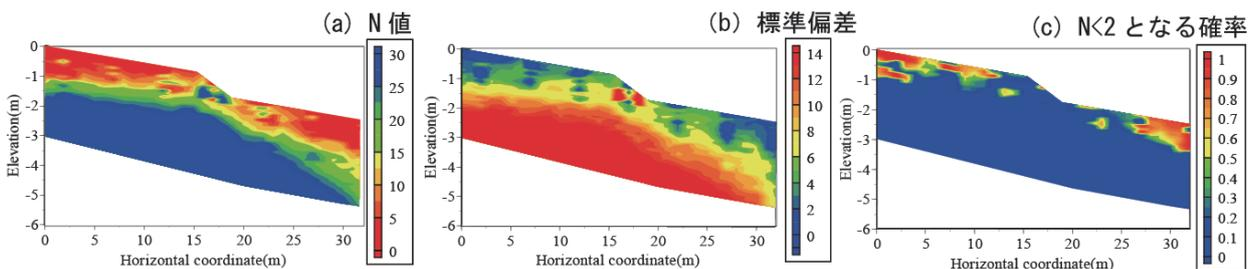
図-9 IS による  $N_{SPR}$  分布 (DCP に基づく)
