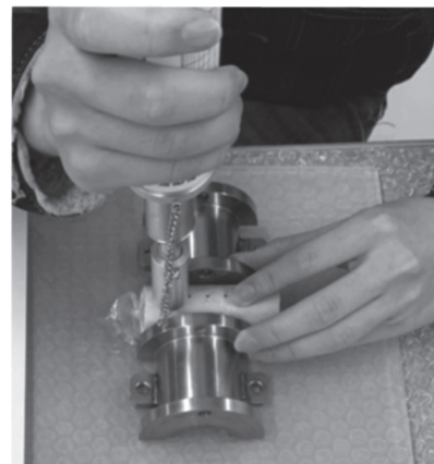
写真-2 針貫入試験の実施状況
