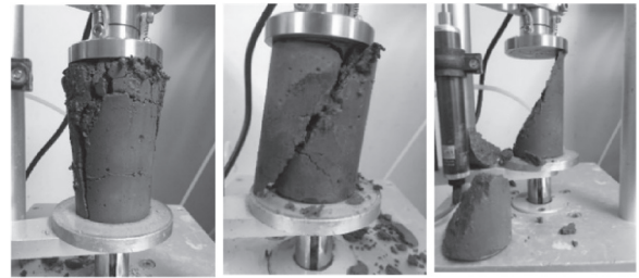
(a)樽型破壊 (b) 非攪乱部の破壊 (c) 滑落 写真-1 一軸試験後の供試体の様子
