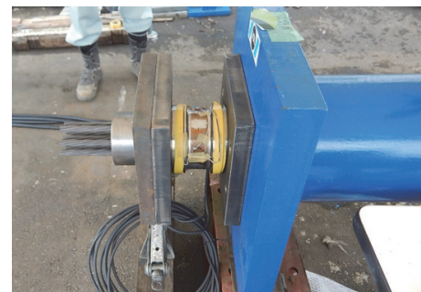
図-24 精度確認試験状況 (補修荷重計)
