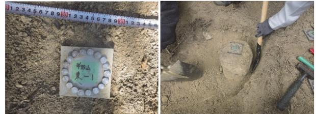
写真-5 釘打ち込み法によるサンプリング状況
