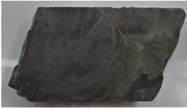
写真-3 崩壊地から採取された泥岩の研磨試料 (横 9cm)
