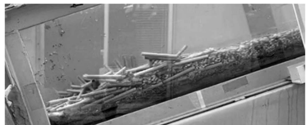
写真-6 流木混じりの土石流の流木塊形成時の状況
