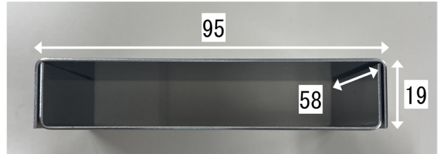
写真-2 応力集中低減カバー (単位: mm)
