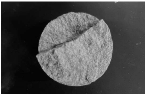
図-5 作製された供試体 (Particle1 含水比40%)
