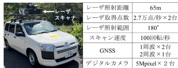
図-1 MMSの概観と機器の仕様
