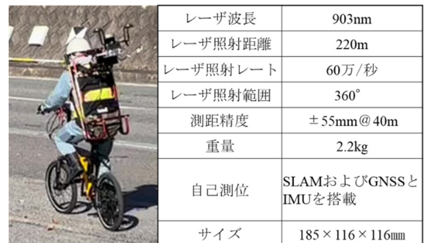
図-2 LidarSLAMの概観と機器の仕様
